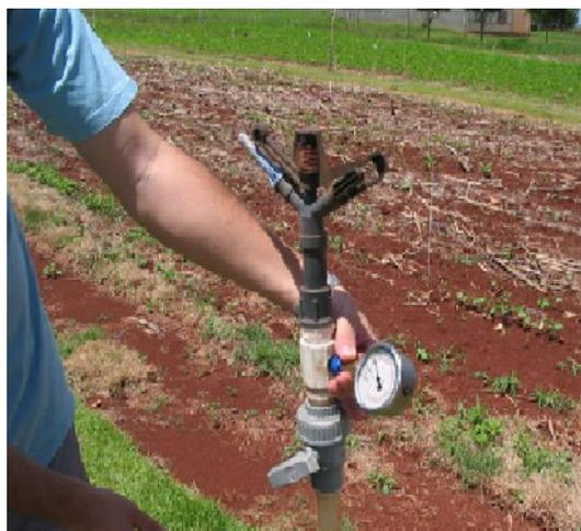
Figura 2. Regulagem da pressão de serviço do aspersor, através de registro de esfera e manômetro.
