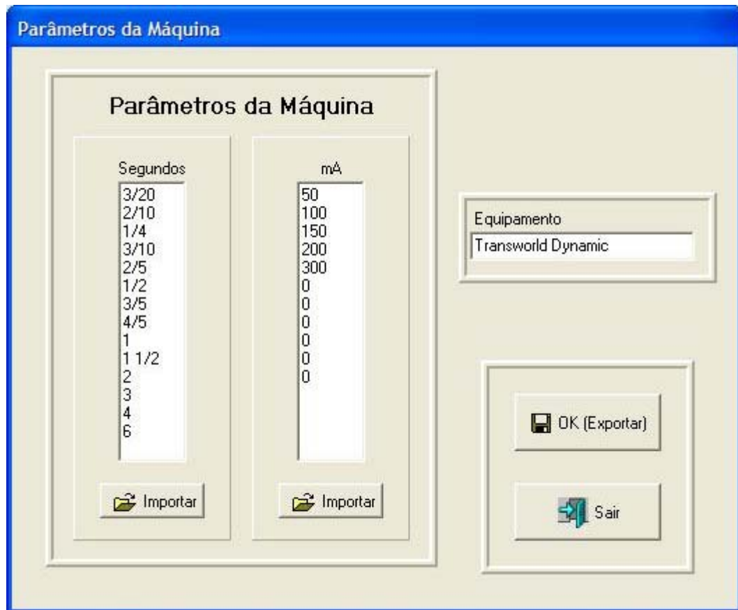
Figura 4.18 – Interface para cadastro dos valores de corrente e de tempo existentes no aparelho de raios X.
