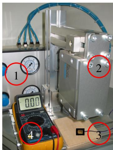
**Figura 10:** Dispositivo de calibração: 1) Painel de controle (válvulas de ajuste de pressão e acionamento dos pistões); 2) Dispositivo pneumático com pistões; 3) Sensor de pressão e 4) Multímetro digital.
