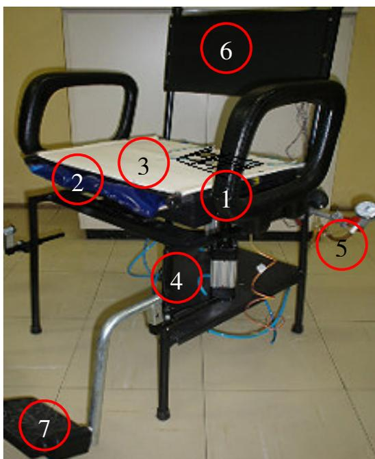
**Figura 3:** Cadeira de teste: 1) Assento móvel; 2) Almofada tipo caixa de ovo; 3) Tecido do assento; 4) Cilindro pneumático; 5) Manômetro analógico; 6) Apoio lombar e 7) Apoio para os pés.
