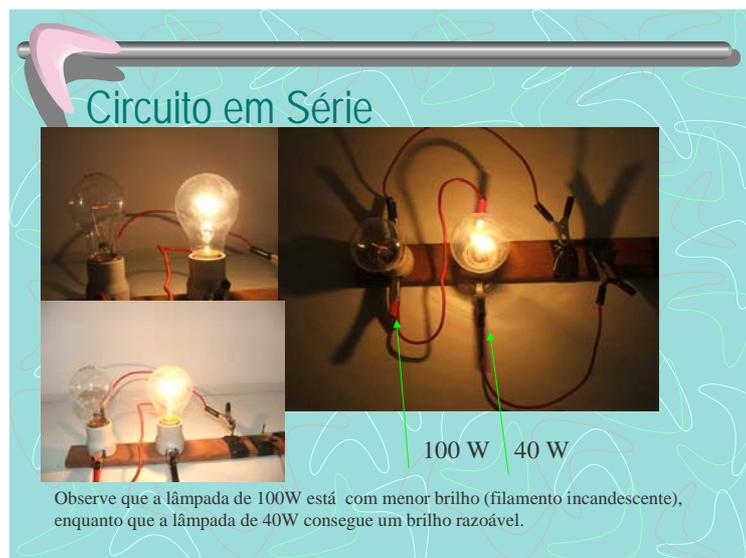
Figura II.24 – Slide do circuito em série em funcionamento
