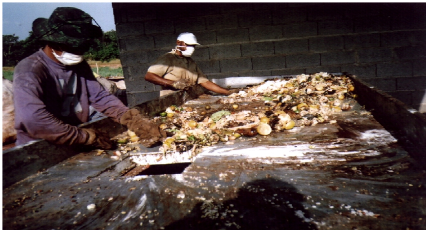
Figura 24 - Vista parcial da mesa de separação de lixo úmido
