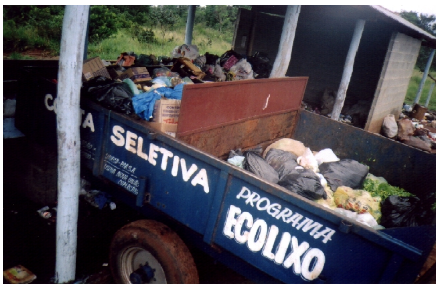
Figura 21 - Vista da divisória do compartimento de carga do veículo coletor
