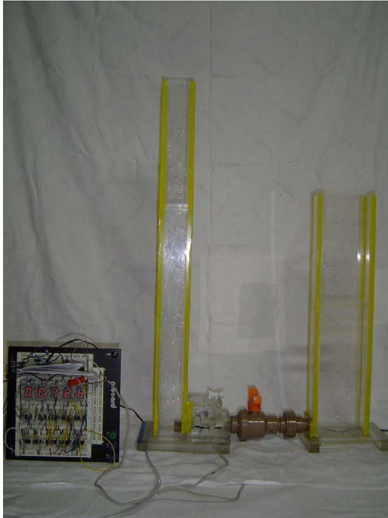
Figura 6 – Foto do protótipo dos vasos comunicantes.
