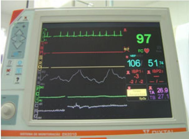
Figura 36: Monitor multiparamétrico com função de mensuração de pressão arterial indireta por oscilometria.
