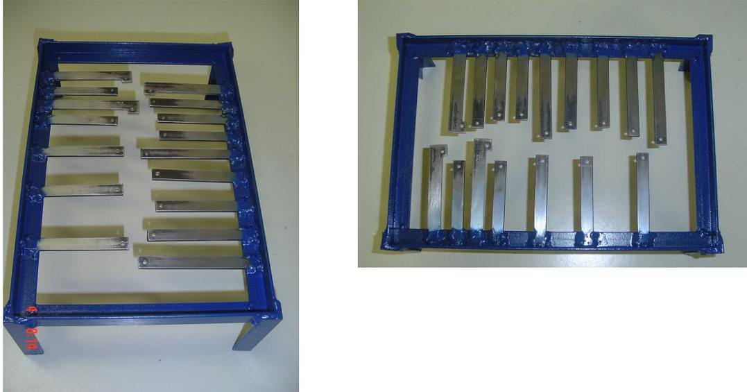
Figura 17 - Detalhe das vigas soldadas no sensor do pé direito.
