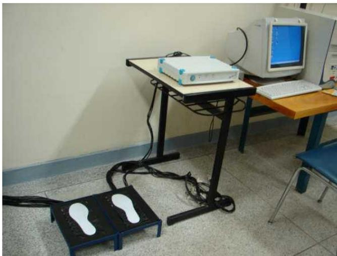
Figura 35 – Detalhe da ponte amplificadora e das plataformas de força.
