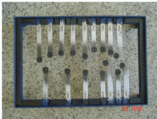
Figura 20 - Detalhe das borrachas coladas nas vigas.
