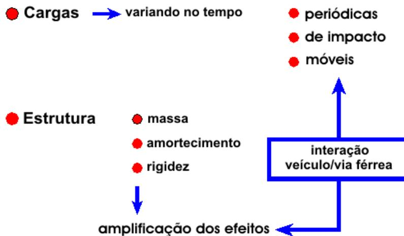
Figura 2.6: Aspectos dinâmicos envolvidos na análise da interação entre veículo e ferrovia.
