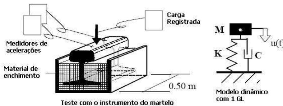
Figura 2.10: Modelo dinâmico experimental (Esveld-1998)
