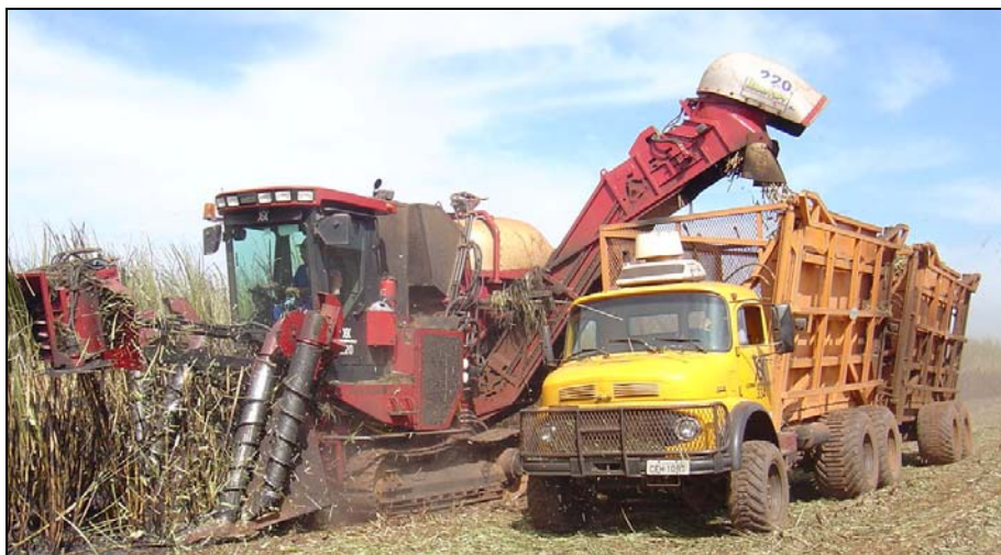
FIGURA 5.6 - Colhedora e caminhão transbordo em operação
