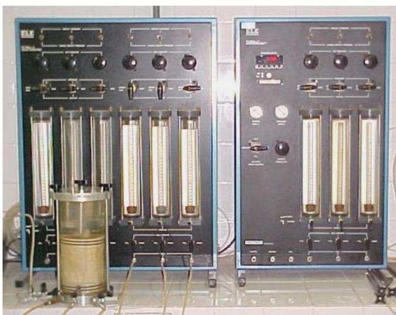
**Figura 4.5** - Permeômetro de Parede flexível Tri-Flex.
