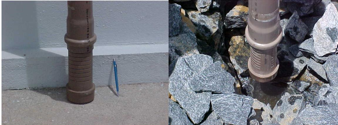
**Figura 3.10** - Detalhe do Piezômetro.
