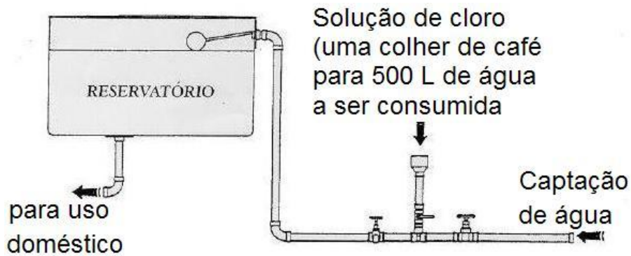
Figura E.1: Cloração de água do reservatório
