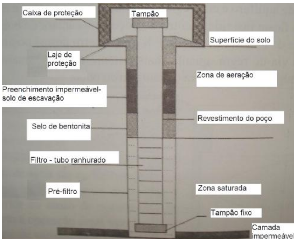
Figura 2.8: Perfil esquemático de um poço de monitoramento e amostragem (FREITAS, 1997).
