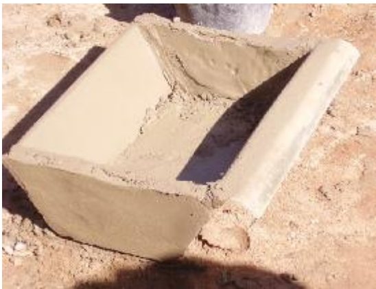
Figura 5.3: Caixa construída com impermeabilizante, para a determinação de pH.
