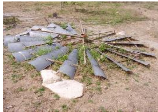
(d) Palhetas do catavento danificadas e abandonadas (localidade de Monte Alegre Velho)
