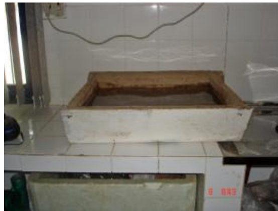
Figura 5.4: Caixa construída sem impermeabilizante, para a determinação de pH.
