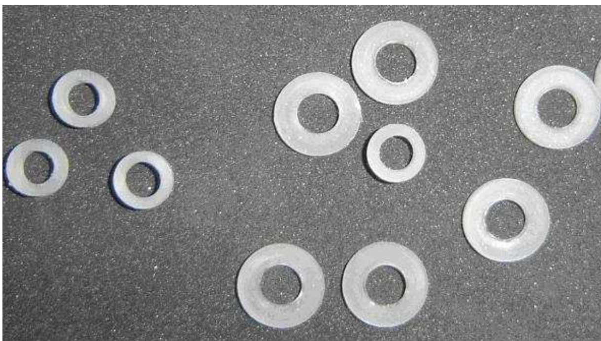
Figura 3.14 - Isoladores de silicone.
