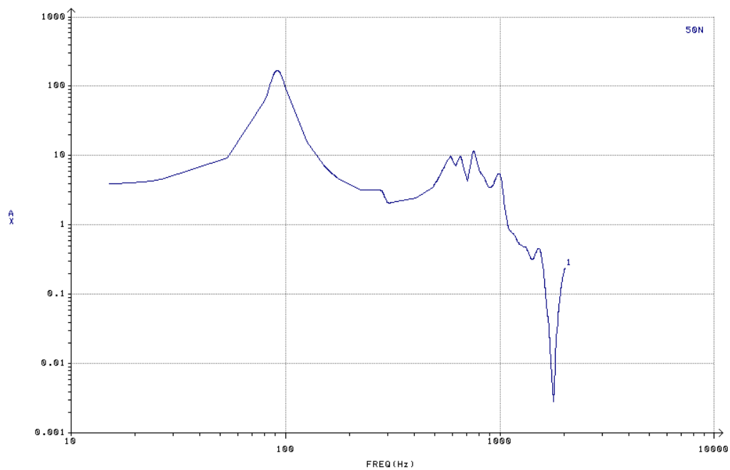
Figura 4.30 - Aceleração PSD [ m^2/s^4Hz ] x Frequência [Hz] – nó 50.
