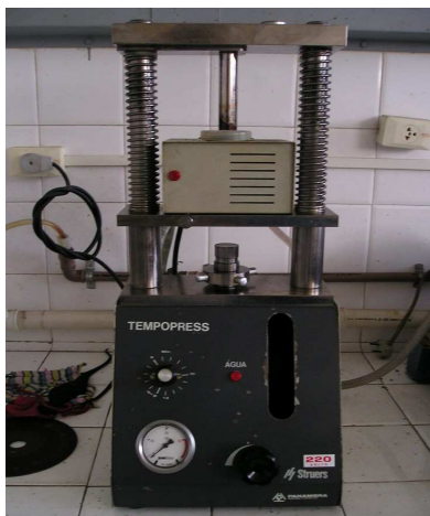
Figura 41 - Equipamento Tempopress do DMT/FEG/UNESP onde foram realizados os embutimentos das amostras para a análise metalográfica.
