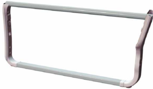
Figura 10 - Estrutura da porta. Tubos verticais em aço, hidroconformados e horizontais em aços de alta e ultra-alta resistência.
