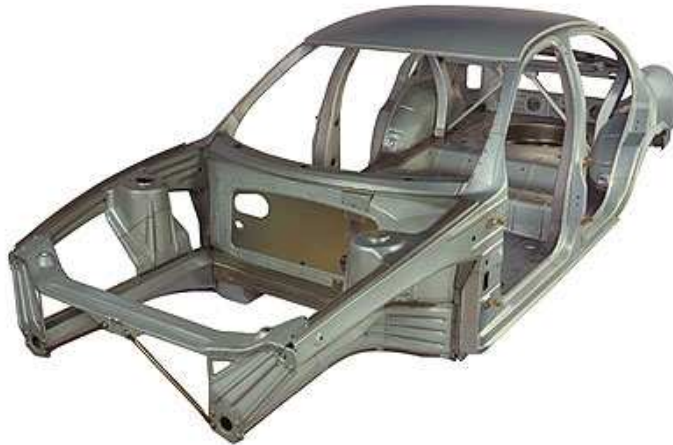
Figura 4 - Estrutura desenvolvida no projeto ULSAB. Vista frontal superior (ULSAB OVERVIEW REPORT – PHASE 2, 1998).
