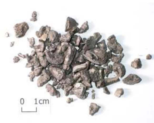
Figura 11 - Aspecto dos finos de esponja utilizados para obtenção de pó de titânio.
