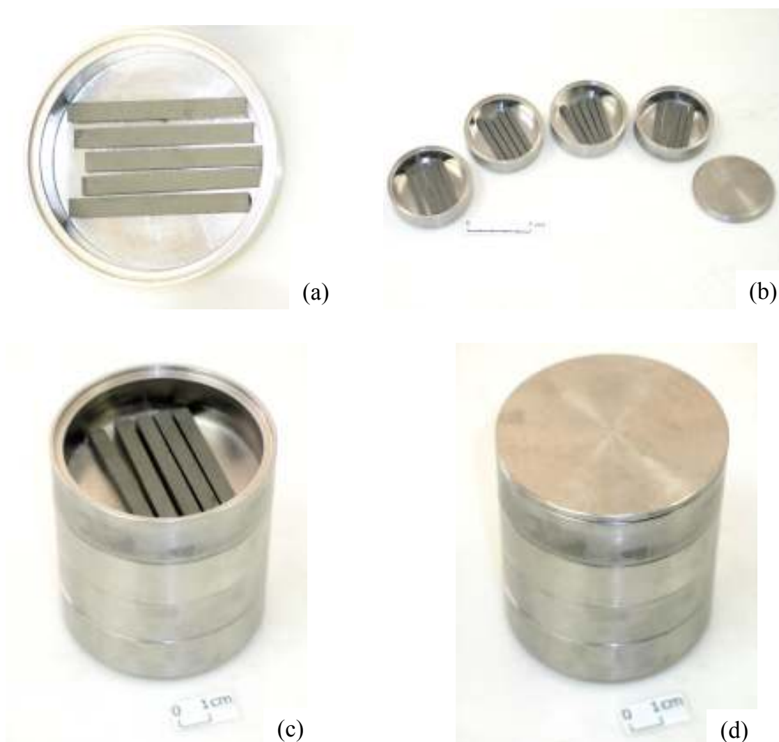
Figura 19 - Detalhes do cadinho e da forma de carregamento dos corpos-de-prova para sinterização. (a) detalhe dos corpos-de-prova; (b) conjunto dos cadinhos; (c) montagem dos cadinhos; e (d) montagem final.
