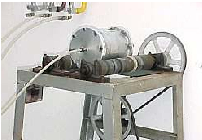
Figura 13 – Detalhe do moinho de bolas utilizado para moagem dos materiais após a fragilização.
