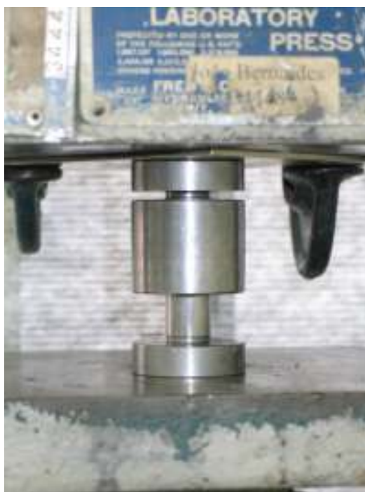
Figura 15 - Matriz de compactação cilíndrica de 15 mm de diâmetro.
