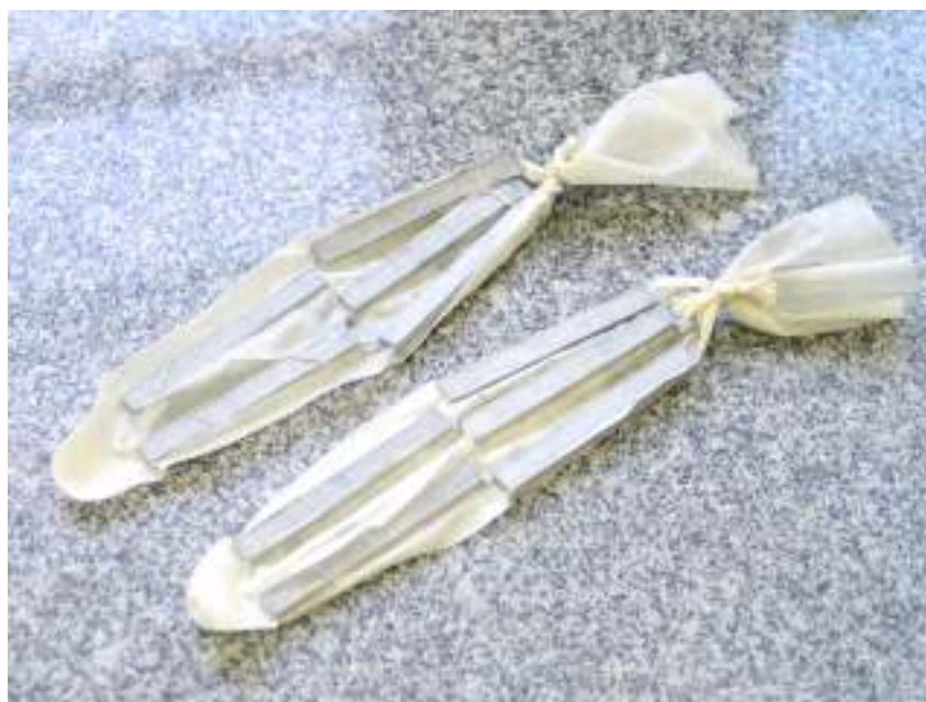
Figura 17 - Detalhe dos corpos-de-prova encapsulados para a etapa de prensagem isostática frio.
