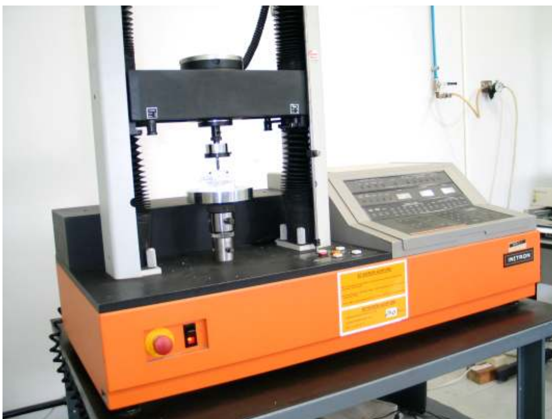
Figura 20 - Detalhes da máquina de ensaio INSTRON modelo 4301 utilizada para ensaio da liga Ti-35Nb, em flexão de três pontos, à temperatura ambiente.
