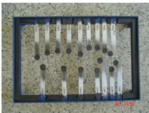
Figura 12- Detalhe das borrachas coladas nas vigas (TEODORO, 2006).
