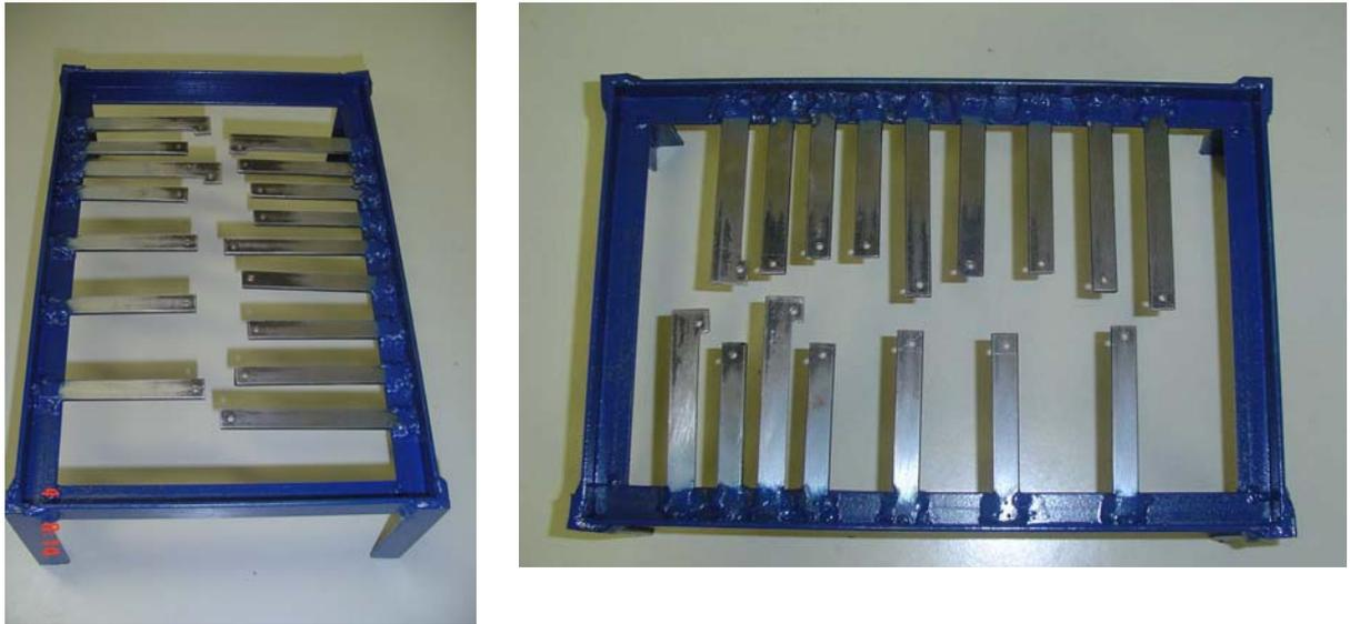
Figura 9- Detalhe das vigas soldadas no sensor do pé direito (TEODORO, 2006).
