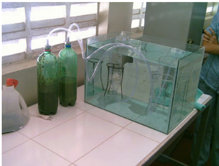
Figura 3.7 – Biodigestor experimental construído pelos alunos de Caçapava.
