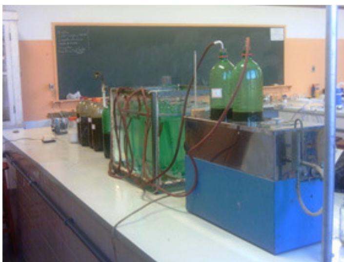
Figura 3.3 – Foto do biodigestor utilizado nas aulas de química.
