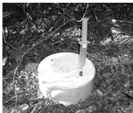
Figura 4. Câmara de medição de fluxo de CO_2 do solo, com seringa acoplada.
