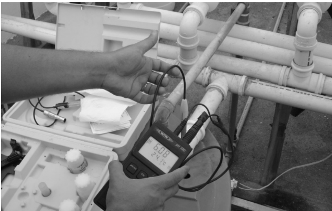
Figura 13. Momento da medição do pH e da temperatura na solução nutritiva contida nos reservatórios. Após a medição o volume de água é ajustado e o pH corrigido para 6. O aparelho utilizado foi o pH Meter da WTW Wissenschaftlich-Technische Werkstätten, modelo 320.
