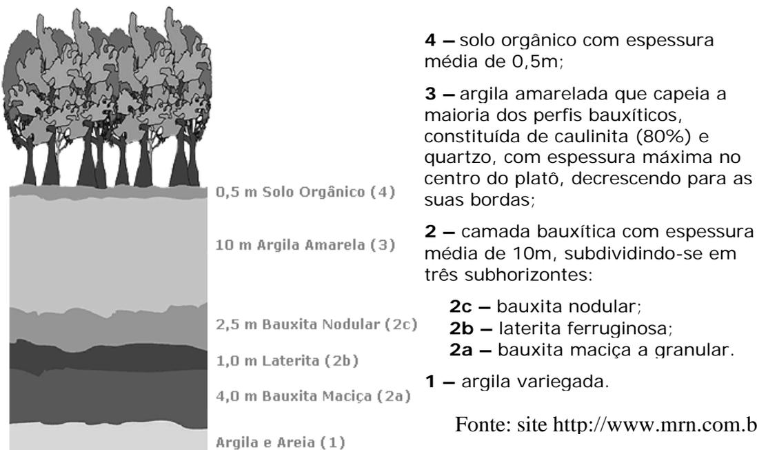
**Figura 01.** Perfil típico de ocorrência da bauxita em Porto Trombetas (PA).
