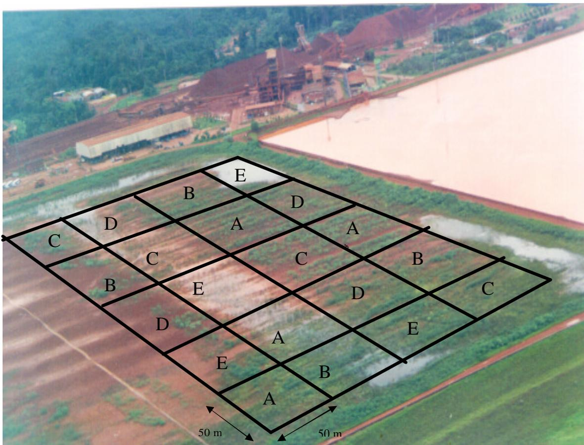
**Figura 09.** Vista parcial do tanque de rejeito SP1 após hidrossemeadura e croqui aproximada da disposição das parcelas do experimento de níveis de adubação e calagem em rejeito ácido da lavagem da bauxita em Porto Trombetas (PA).
