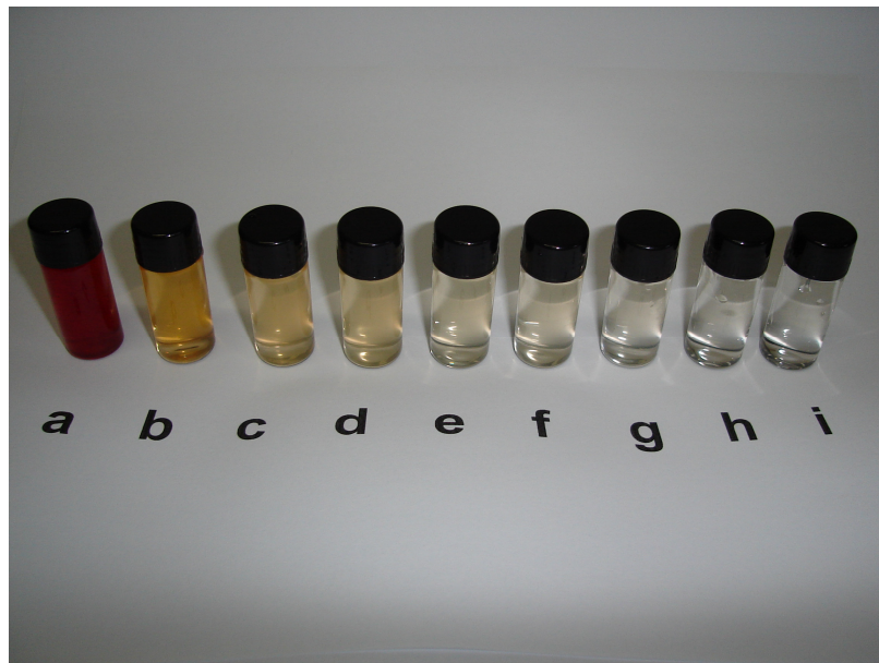
Figura 18: Amostras da solução de corante vermelho tratadas pelo processo fotoeletroquímico (a = 0 minutos, b = 2 minutos, c = 4 minutos, d = 6 minutos, e = 10 minutos, f = 15 minutos, g = 30 minutos, h = 45 minutos, i = 60 minutos).
