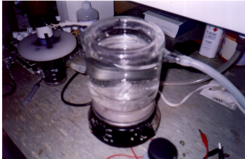
Figura 13: solução de corante azul tratada após 45 minutos no reator fotoeletroquímico.
