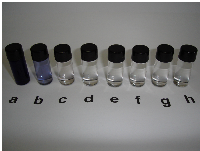
Figura 14: Amostras da solução de corante azul tratadas pelo processo fotoeletroquímico (a = 0 minutos, b = 2 minutos, c = 4 minutos, d = 6 minutos, e = 10 minutos, f = 15 minutos, g = 30 minutos, h = 45 minutos).
