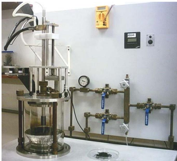
**Figura 3.3.** Foto do reator de arco construído para a preparação de NTCPS.
