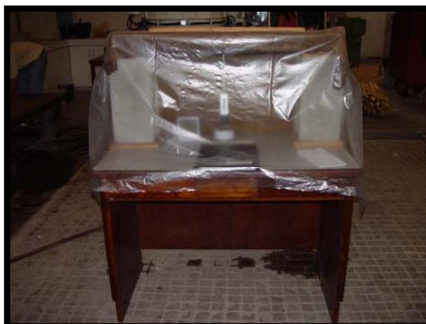
Figura 3.4 – Capela para realização do ensaio de início e fim de pega.
