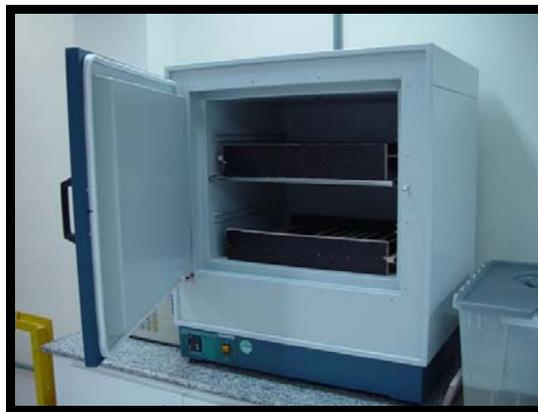
Figura 3.16 – Estufa calibrada a 80°C para a secagem da água livre.
