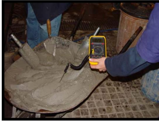
Figura 3.8 – Medição da temperatura da pasta PS.
