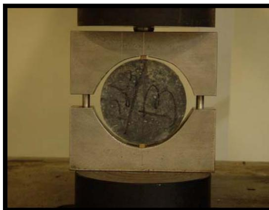
Figura 3.25 – Ensaio de resistência à tração.
