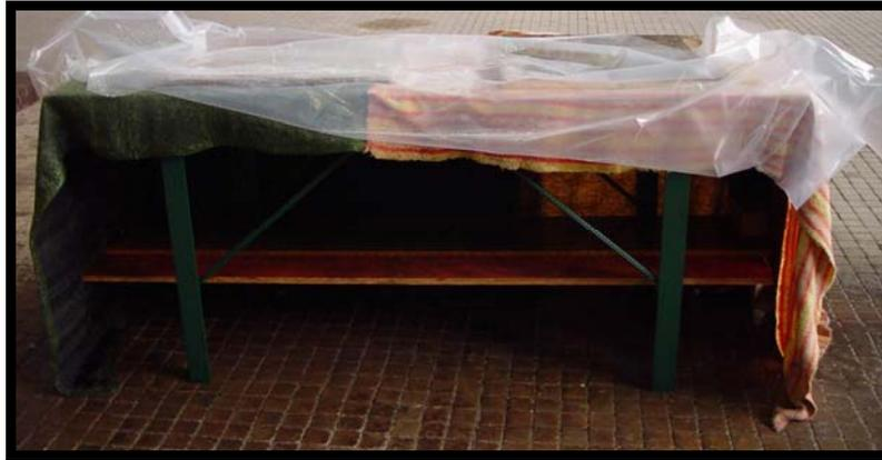
Figura 3.11 – Cura dos corpos de prova nas primeiras 24 horas.
