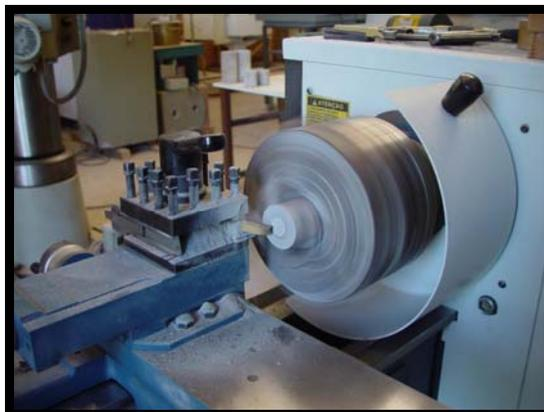
Figura 3.21 – Faceamento de corpo de prova em torno mecânico.
