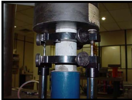
Figura 3.20 – Ensaio com medição de deformação.
