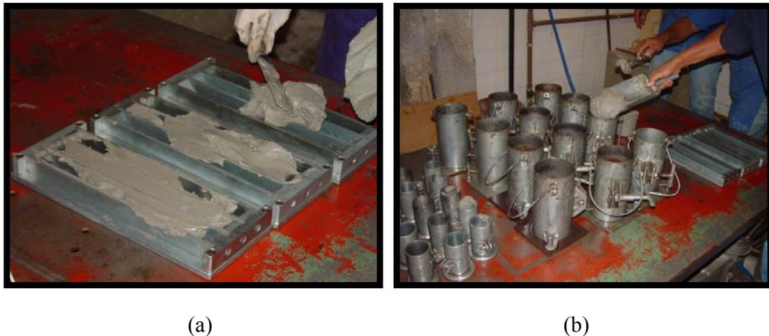
Figura 3.10 – Moldagem da pasta PS: (a) moldagem dos corpos de prova prismáticos para estudo da retração; (b) moldagem dos corpos de prova cilíndricos para a determinação das propriedades mecânicas.
