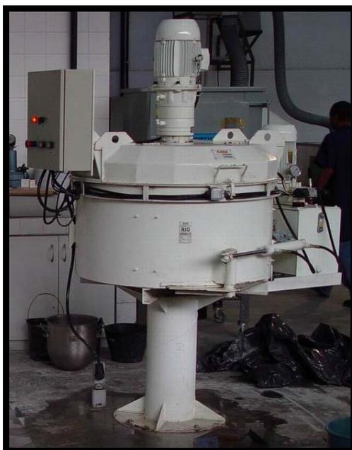
Figura 3.6 – Misturador planetário utilizado na produção das pastas pozolânicas.
