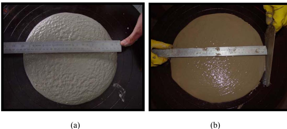
Figura 3.9 – Medição do espalhamento na mesa de consistência: (a) pasta PC; (b) pasta PM.
