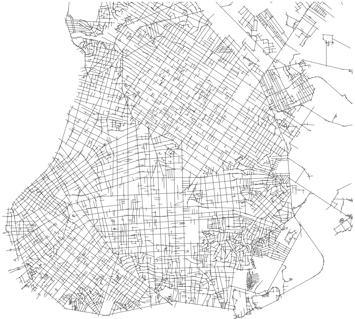
Figura 3.26 – Representação linear de parte da cidade de Belém – PA. No entorno das áreas em tabuleiro planejado existem regiões periféricas com estruturação mais parecida com aquelas de crescimento orgânico ou irregular. Observe-se também que nas áreas em grelha há uma grande quantidade de pequenos segmentos que correspondem aos acessos às vilas, padrão grandemente comum na capital paraense, criado para preencher os miolos dos grandes quarteirões. Escala Aproximada: 1:150000.
