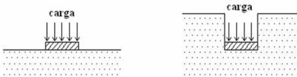
Figura 2.9- Ensaio de Placa: (a) na superfície e (b) em cava
