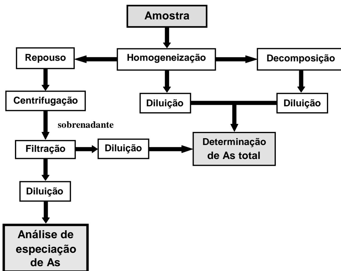
**Figura 6.** Procedimento geral do preparo da amostra para a determinação da concentração total e análise de especiação de arsênio no subproduto aquoso do processo de pirólise do folhelho betuminoso.
