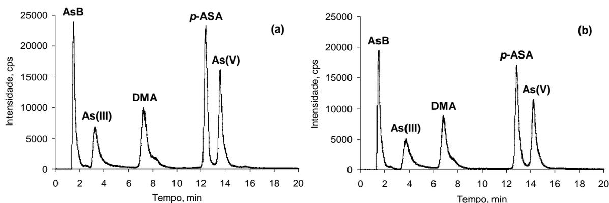
**Figura 11.** Influência do pH da fase móvel na separação das espécies de arsênio. (a) pH 8,6 e (b) pH 8,8. Eluição isocrática e vazão da fase móvel de  $1,4 \text{ ml min}^{-1}$ . Programa de eluição: 7 min a  $0,0015 \text{ mol l}^{-1}$  de  $(\text{NH}_4)_2\text{CO}_3$  e 13 min a  $0,02 \text{ mol l}^{-1}$  de  $(\text{NH}_4)_2\text{CO}_3$ . Injeção de  $200 \mu\text{l}$  de solução mista com  $10 \mu\text{g l}^{-1}$  (como As) de AsB, As(III), DMA, *p*-ASA e As(V).
