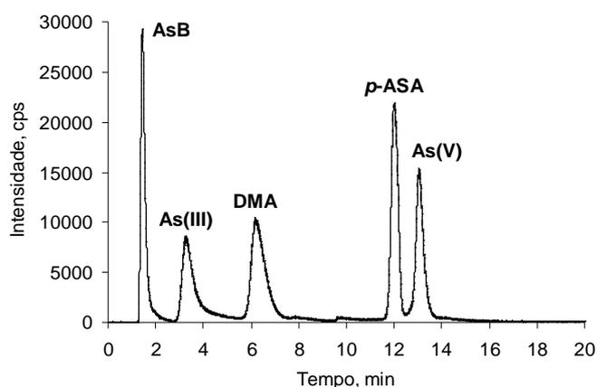
**Figura 14.** Cromatograma obtido quando a eluição é feita em duas etapas. Eluição isocrática em pH 8,7 e vazão da fase móvel de 1,5 ml min<sup>-1</sup>. Programa de eluição: 7 min a 0,0015 mol l<sup>-1</sup> de (NH<sub>4</sub>)<sub>2</sub>CO<sub>3</sub> e 13 min a 0,02 mol l<sup>-1</sup> de (NH<sub>4</sub>)<sub>2</sub>CO<sub>3</sub>. Injeção de 200 µl de solução de referência mista com 10 µg l<sup>-1</sup> (como As) de AsB, As(III), DMA, *p*-ASA e As(V).
