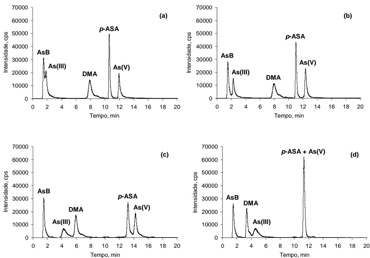
**Figura 10.** Efeito do pH da fase móvel na separação das espécies. (a) pH 7; (b) pH 8; (c) pH 9; (d) pH 10. Eluição isocrática e vazão da fase móvel de  $1,4 \text{ ml min}^{-1}$ . Programa de eluição: 7 min a  $0,0015 \text{ mol l}^{-1}$  de  $(NH_4)_2CO_3$  e 13 min a  $0,02 \text{ mol l}^{-1}$  de  $(NH_4)_2CO_3$ . Injeção de  $200 \mu\text{l}$  de solução mista com  $10 \mu\text{g l}^{-1}$  (como As) de AsB, As(III), DMA, *p*-ASA e As(V).
