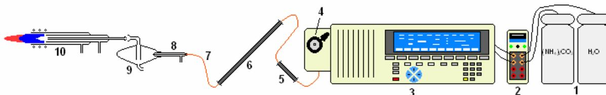
**Figura 5.** Esquema do sistema LC-ICP. 1. fase móvel; 2. degaseificador a vácuo; 3. bomba de LC; 4. injetor; 5. coluna guarda (troca aniônica); 6. coluna analítica (troca aniônica); 7. tubos de PEEK; 8. nebulizador; 9. câmara de nebulização e 10. plasma.
