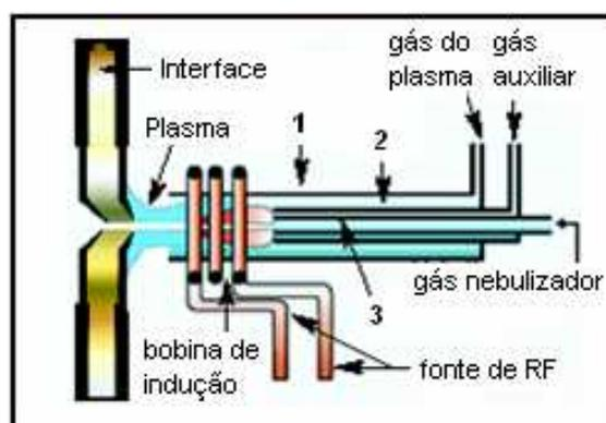
**Figura 4.** Vista detalhada da tocha, plasma e interface. 1. tubo externo; 2. tubo intermediário e 3. tubo injetor.<sup>148</sup>
