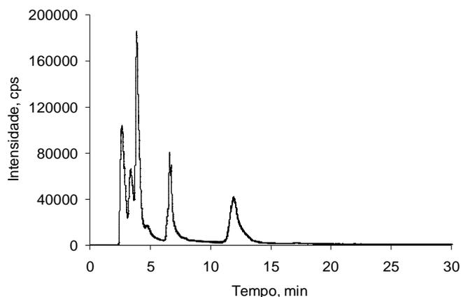
**Figura 7.** Cromatograma obtido a partir de uma solução contendo As(III), As(V), DMA, *p*-ASA e AsB, na concentração de  $50 \mu\text{g l}^{-1}$  (como As) de cada espécie, com injeção de  $200 \mu\text{l}$ . Eluição isocrática a pH 8,5 e vazão da fase móvel de  $0,8 \text{ ml min}^{-1}$ . Programa de eluição: 7 min a  $0,015 \text{ mol l}^{-1}$  de  $(\text{NH}_4)_2\text{CO}_3$  e 23 min a  $0,05 \text{ mol l}^{-1}$  de  $(\text{NH}_4)_2\text{CO}_3$ .
