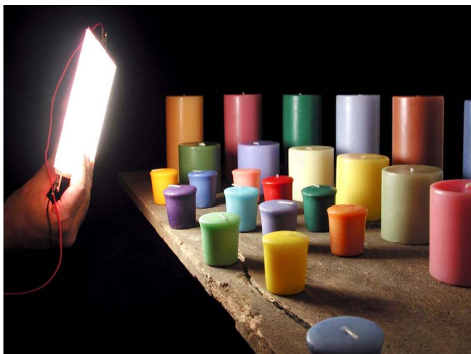
Fig. 6.23 – Passado e futuro da iluminação ambiente. Um OLED branco produzido pela GE Global Research , que produz 70 lúmens e com uma eficiência de 7 lm/W.
