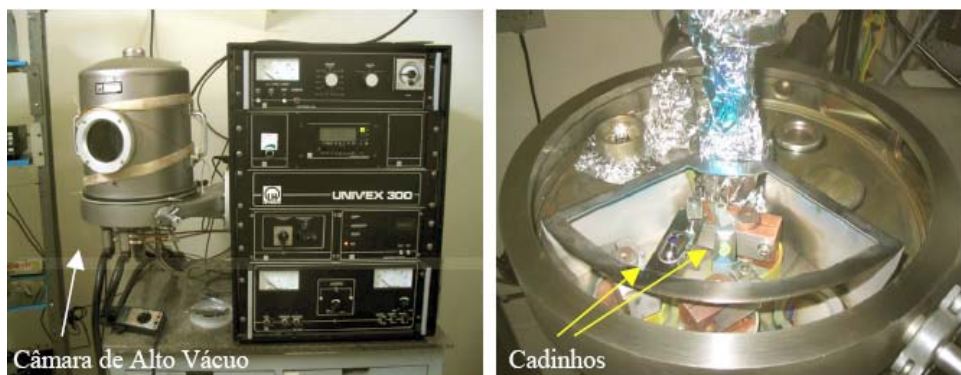
Fig. 4.1 – Fotos mostrando o equipamento de deposição utilizado (UNIVEX 300) (esquerda) e parte interior da câmara de alto vácuo, onde são colocados os cadinhos com os materiais a serem depositados.
