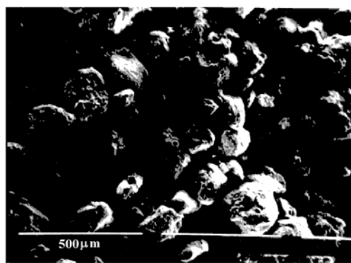
Figura II.15 - Eletromicrografia da textura em amostra compactada estaticamente com \gamma_s = 17,00\text{kN/m}^3 e w = 3,0\% (GUIMARÃES NETO, 1997).
