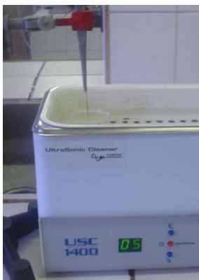
a) UltraSonic Cleaner. b) Limpeza por ondas de cavitação. c) Anel na cor rubra durante aquecimento.
