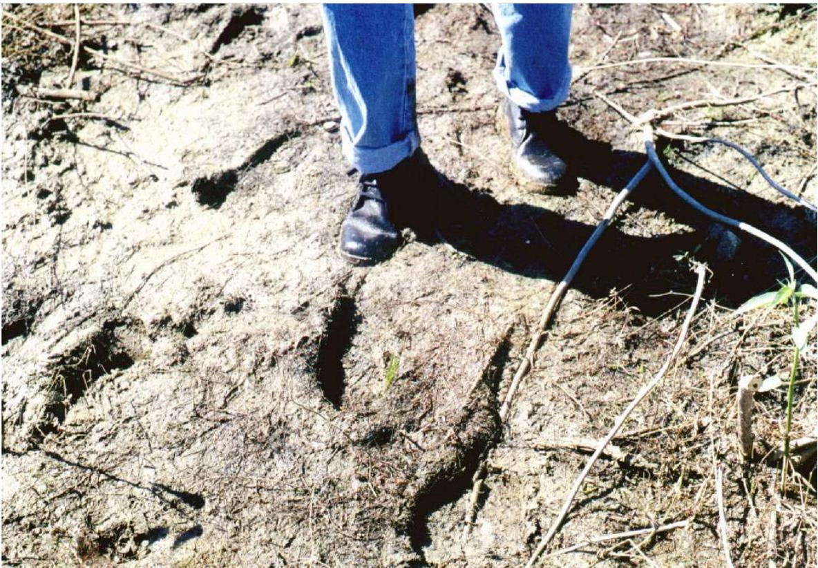
Figura 2.7 –Perda aparente da capacidade de suporte do solo (CHESF, 1997).
