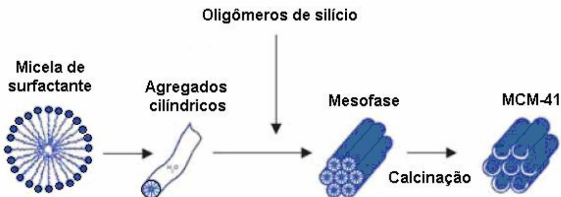
Figura 6. Mecanismo de síntese da fase MCM-41.
