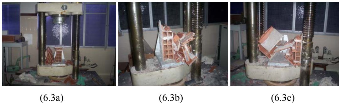
Figura 6.3 - Formas de ruptura dos prismas sem revestimento (6.3a) e chapiscados (6.3b) e (6.3c)
