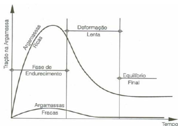
Figura 2.9 – Comportamento das tensões nas argamassas, FIORITO (1994)
