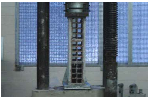
Figura 6.7 (a) – Prisma com 2 cm de revestimento antes da ruptura
