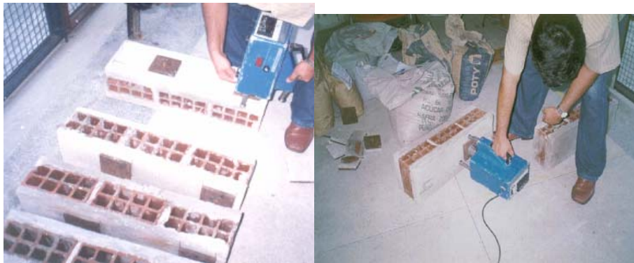
Figura 3.9 – Ensaio de resistência de aderência à tração
