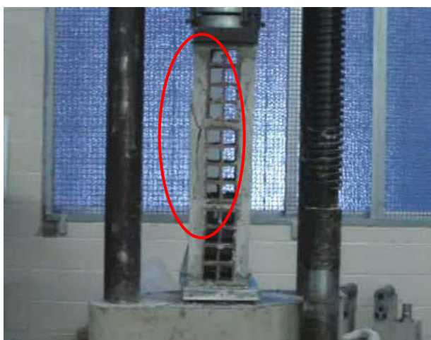
Figura 6.11 (c) – Prisma com 3 cm de revestimento após a ruptura
