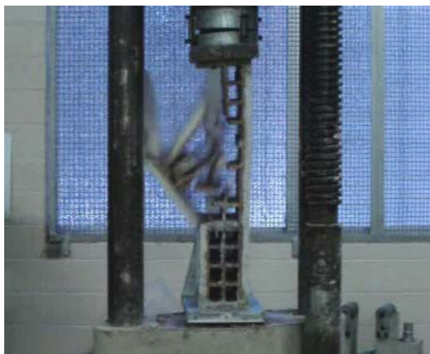
Figura 6.7 (c) – Prisma com 2 cm de revestimento no instante 2 posterior à ruptura
