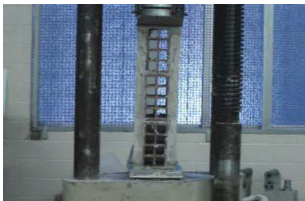
Figura 6.11 (a) – Prisma com 3 cm de revestimento antes da ruptura
