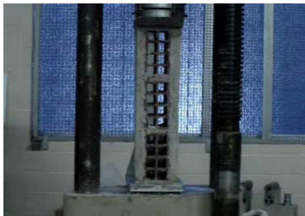
Figura 6.10 (a) – Prisma com 3 cm de revestimento antes da ruptura
