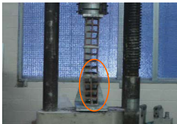
Figura 6.6 (b) – Prisma nu no instante 1 posterior à ruptura
