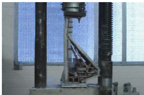
Figura 6.8 (c) – Prisma com 2 cm de revestimento após a ruptura (concluído o ensaio)
