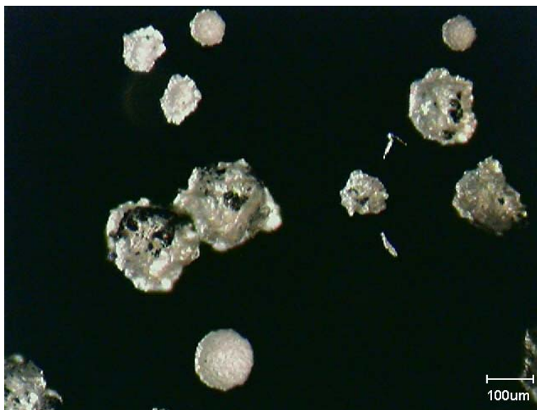
Figura 18 – Micrografia de microscopia ótica do copolímero sintetizado com 10% de ferro tratado com ácido oleico e sem agitação vigorosa (BR-04)
