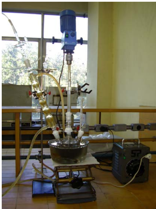
Figura 12 - Aparelhagem utilizada na síntese dos copolímeros com propriedades magnéticas
