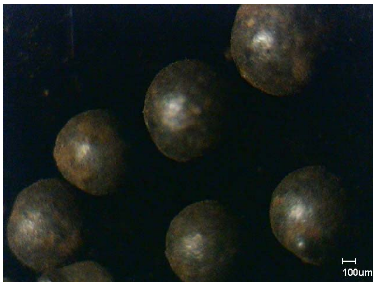
Figura 20 – Micrografia de microscopia ótica do copolímero sintetizado com 20% de ferro tratado com ácido oleico (BA-16) - nova rota de síntese
