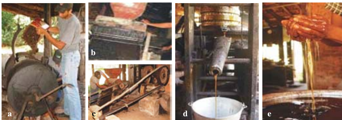
Figura 10 – Maquinário criado pelo produtor rural Cinéias Campelo. Um velho britador adaptado com pequenos pinos quebra o coquinho da macaúba e separa a casca da amêndoa (a); em seguida, a amêndoa segue para o torrador (b); e depois disso para a prensa (c), de onde é retirado o óleo (d) e (e).
