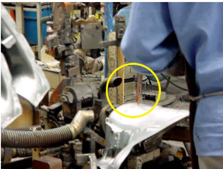
Figura 4.21 – Operação de solda sem o uso do gabarito.
