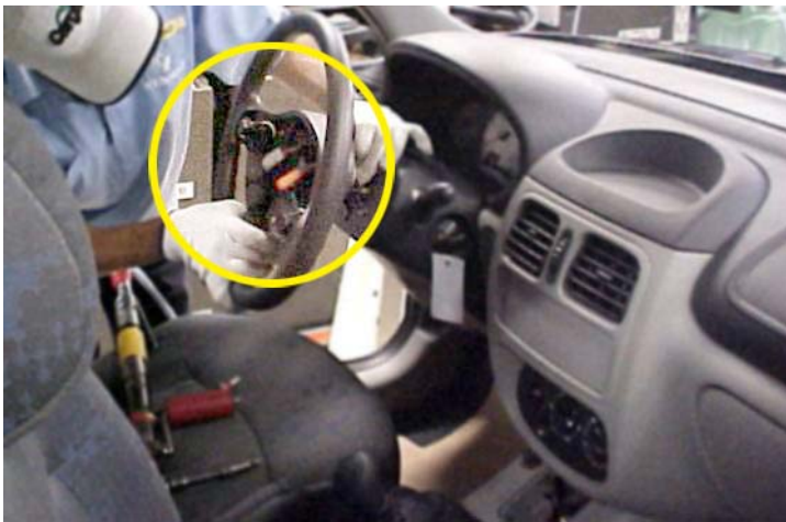
Figura 4.7 – Conectores do air bag e da buzina
