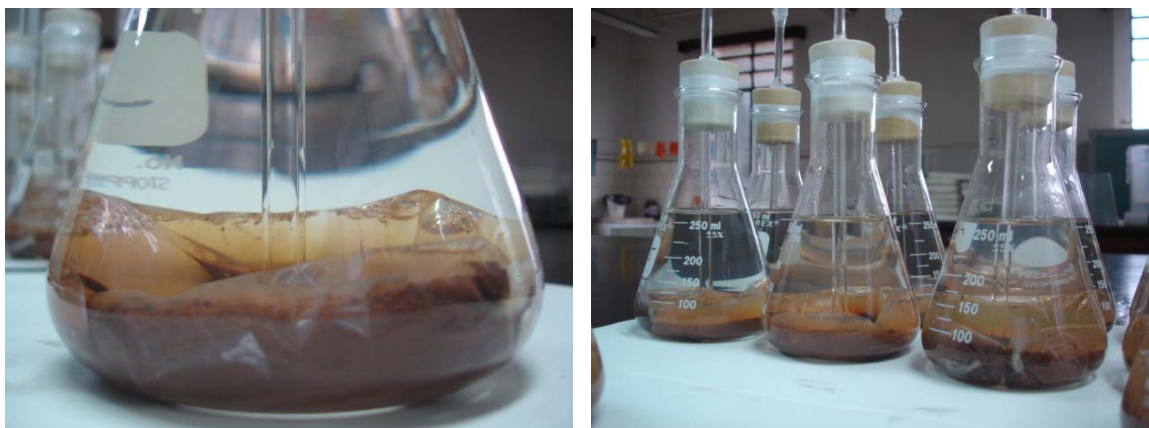
Figura 1: Detalhe da amostra de sedimento envolvida em membrana de diálise e colocada em erlenmeyer com água deionizada (250 ml).
