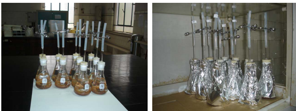
Figura 2: Mangueiras de PVC vedadas com pinça de Mohr, para permitir a injeção de N_2 .
