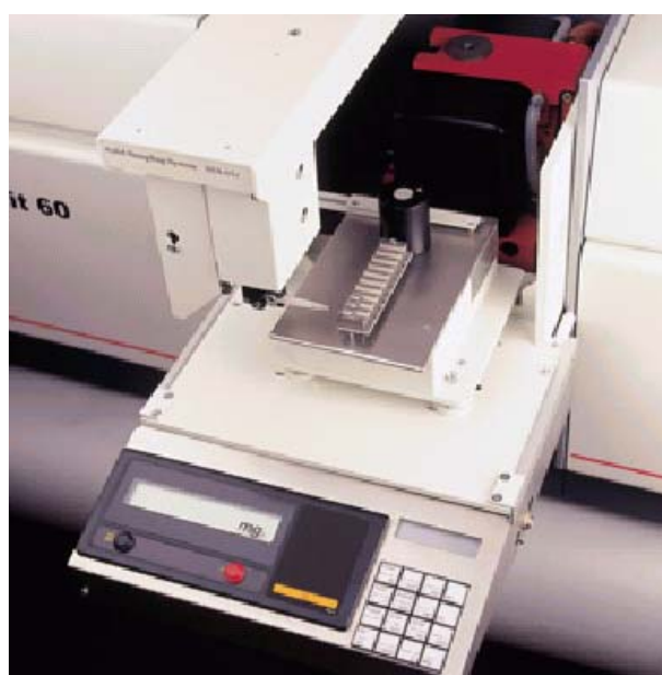
Figura 9. Sistema automatizado de pesagem e amostragem direta de sólidos. 1
