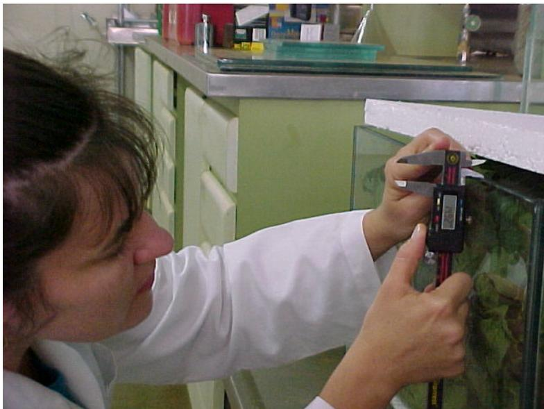
Figura 6 - Medida da variação da altura da embalagem com couve 'Manteiga' com paquímetro digital
