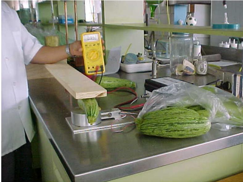
Figura 1 – Medida de compressão realizada com o aparelho firmômetro em abobrinha
