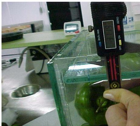
Figura 8 - Medida da variação da altura da embalagem de pimentão 'Magali' com paquímetro digital
