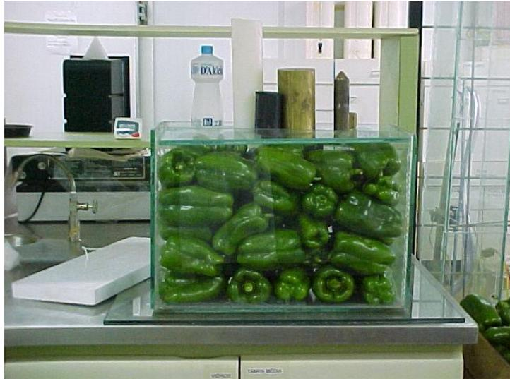
Figura 7 - Caixa de vidro com pimentão 'Magali' submetido à aplicação de força correspondente ao dobro do peso da carga da embalagem
