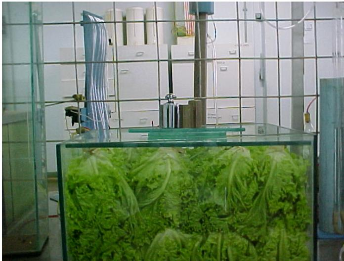
Figura 4 - Aplicação de força correspondente ao dobro do peso da carga contida na embalagem
