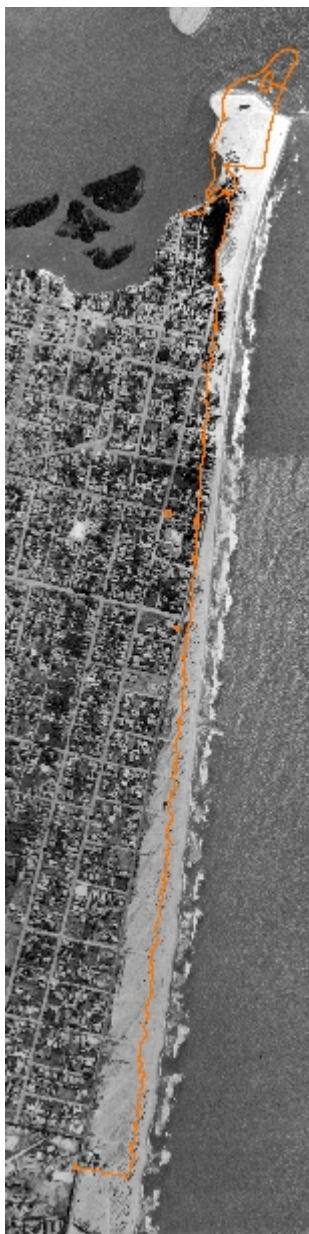
Figura 27: Resultado do levantamento planimétrico da falésia para janeiro de 2005 (linha em cor laranja).
