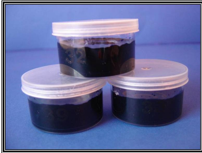
Figura 39 – Espécimes colocados em frascos com azul de metileno durante 72h.
