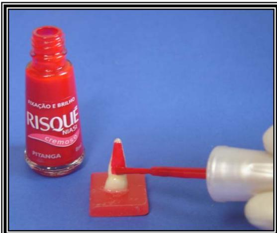
Figura 37 - Aplicação de esmalte para unhas, segundo material impermeabilizador.
