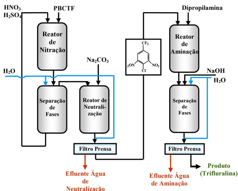
**Figura 1.** Fluxograma parcial da produção do herbicida trifluralina e a geração de correntes efluentes<sup>4,22</sup>. PCBTF = p-cloro-trifluoro-benzeno.
