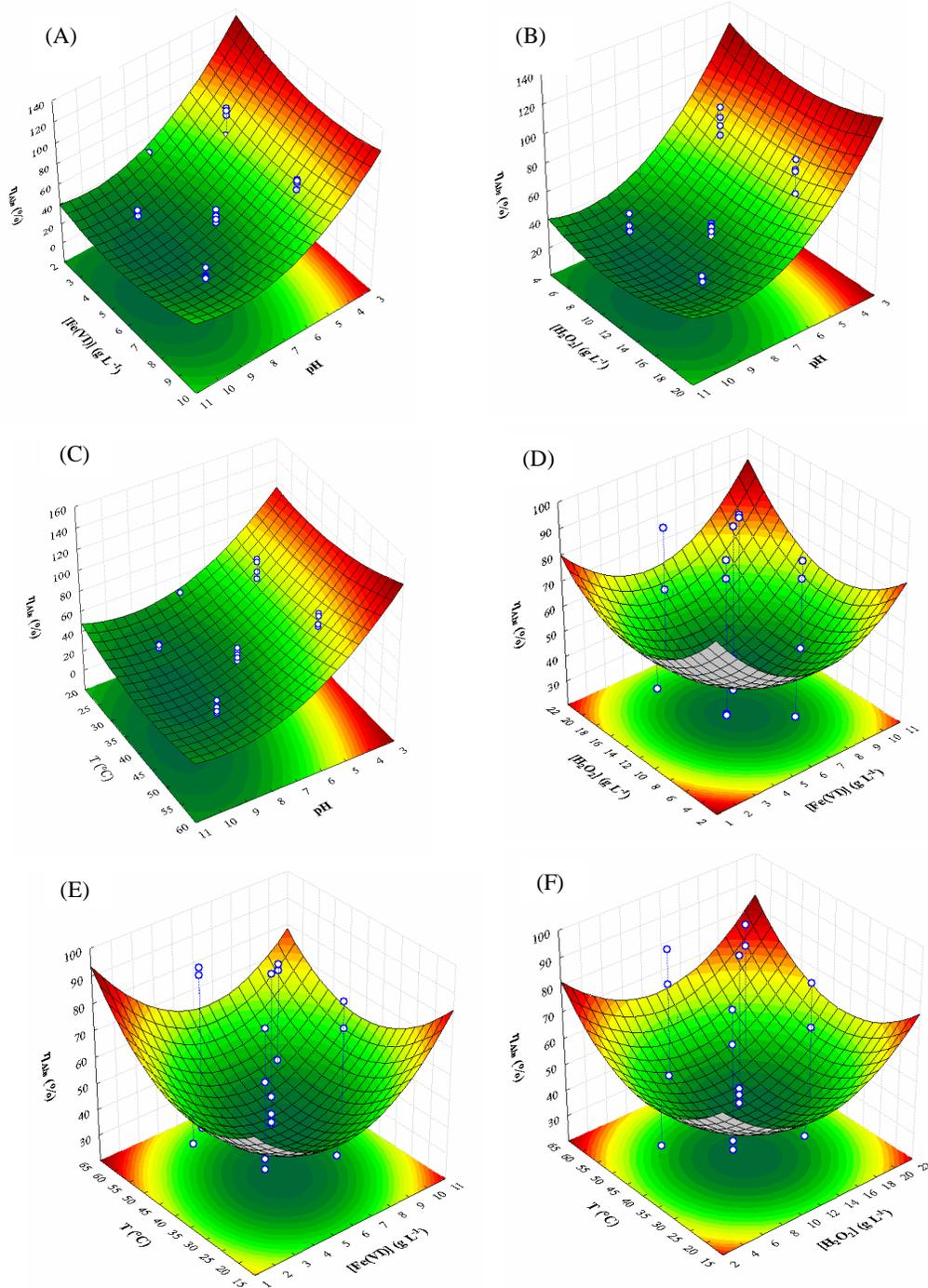
**Figura 28.** Superfície de resposta para a redução de cor absorciométrica do efluente AA por oxidação-coagulação-foto-Fenton (500 mL, AA 100%, 240 min, 420 nm). (A) pH vs [Fe(VI)]→[Fe(III)], (B) pH vs [H<sub>2</sub>O<sub>2</sub>], (C) pH vs T, (D) [Fe(VI)]→[Fe(III)] vs [H<sub>2</sub>O<sub>2</sub>], (E) T vs [Fe(VI)]→[Fe(III)], (F) T vs [H<sub>2</sub>O<sub>2</sub>].
