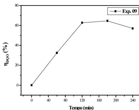
**Figura 21.** Acompanhamento da eficiência da remoção da DQO do efluente AA para o processo de oxidação-coagulação-Fenton (500 mL AA 100%, 240 min de tratamento). (■) pH 3,  $[\text{Fe(VI)}]$   $6 \text{ g L}^{-1}$ ,  $[\text{H}_2\text{O}_2]$   $12 \text{ g L}^{-1}$ .
