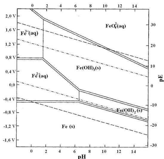
**Figura 4.** Diagrama de Pourbaix (potencial redox *versus* pH) para concentrações de ferro 1 mol L<sup>-1</sup>. (Wulfsberg apud Graham et al.<sup>36</sup>).
