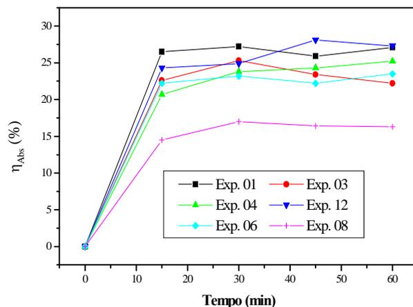
**Figura 13.** Acompanhamento da redução de cor absorciométrica obtida por oxidação-coagulação com  $K_2FeO_4$  (500 mL AA 100%, 60 min de tratamento, medida em 420 nm). (▼) pH 7,  $[Fe(VI)]$   $4,18 \text{ g L}^{-1}$ ; (●) pH 5,  $[Fe(VI)]$   $5,6 \text{ g L}^{-1}$ ; (▲) pH 9,  $[Fe(VI)]$   $5,6 \text{ g L}^{-1}$ ; (■) pH 5,  $[Fe(VI)]$   $2,8 \text{ g L}^{-1}$ ; (◆) pH 7,  $[Fe(VI)]$   $4,18 \text{ g L}^{-1}$ ; (+) pH 10,  $[Fe(VI)]$   $4,18 \text{ g L}^{-1}$ .
