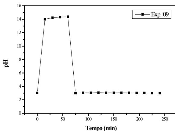
**Figura 24.** Acompanhamento da variação do pH durante o processo de oxidação-coagulação-Fenton. (■) pH 3, [Fe(VI)] 6 g L<sup>-1</sup>, [H<sub>2</sub>O<sub>2</sub>] 12 g L<sup>-1</sup>.
