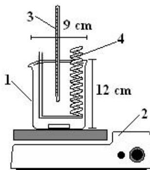
**Figura 9.** Esquema do sistema reacional tanque agitado para oxidação-coagulação e oxidação-coagulação-Fenton. 1: reator; 2: agitador magnético; 3: termômetro; 4: sistema de resfriamento.
