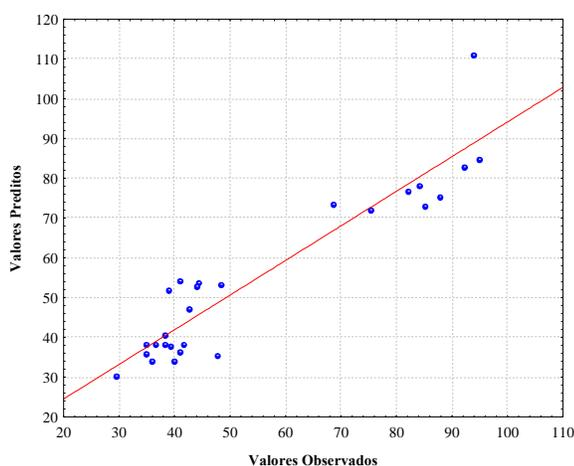
**Figura 30.** Modelo de regressão dos valores observados plotados *versus* os valores preditos da superfície de resposta descrevendo a eficiência da redução da cor absorciométrica por oxidação-coagulação-foto-Fenton ( $R^2 = 0,8709$ ).
