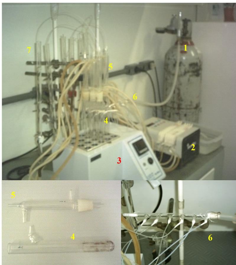
**Figura 8.** Sistema para a determinação da DQO. 1: Cilindro de  $\text{N}_2$ , 2: Bomba peristáltica, 3: Bloco Digestor, 4: Tubo de digestão, 5: Sistema de resfriamento, 6: Distribuidor de gases, 7: Tubo captador de cloretos.
