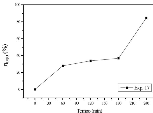
**Figura 29.** Acompanhamento da eficiência da remoção da DQO do efluente AA para o processo de oxidação-coagulação-foto-Fenton (500 mL, AA 100%, 240 min de tratamento). (■) pH 3, [Fe(VI)] 6 g L<sup>-1</sup>, [H<sub>2</sub>O<sub>2</sub>] 12 g L<sup>-1</sup>, 40 °C.
