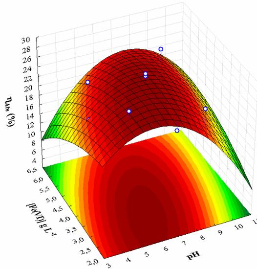
**Figura 14.** Superfície de resposta para o modelo quadrático da redução de cor absorciométrica do efluente água de aminação por oxidação-coagulação com  $K_2FeO_4$  (500 mL AA 100%, 60 min de tratamento, medida em 420 nm).
