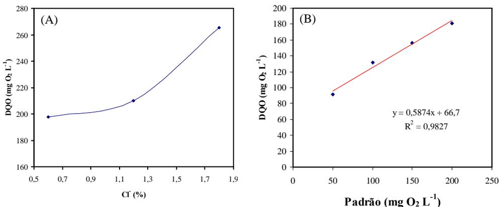
**Figura 12.** (A) Influência da concentração de cloreto sobre a DQO e (B) curva de calibração para padrões de ftalato ácido de potássio. ( $200 \text{ mg O}_2 \text{ L}^{-1}$ ).
