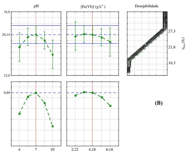
**Figura 16.** (A) Diagrama de Pareto dos efeitos do planejamento estrela e (B) Curva dos principais parâmetros e desejabilidade para a eficiência da redução de cor absorciométrica do efluente AA para o processo de oxidação-coagulação.
