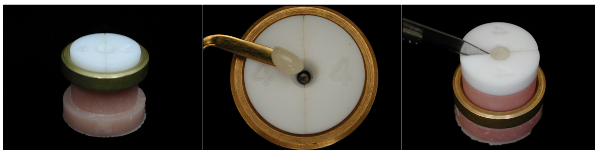
Figura 2: seqüência da inserção dos incrementos de resina ao esmalte, através da matriz em forma de cone truncado (imagem gentilmente cedida pelo Dr. Bruno Lopes da Silveira).
