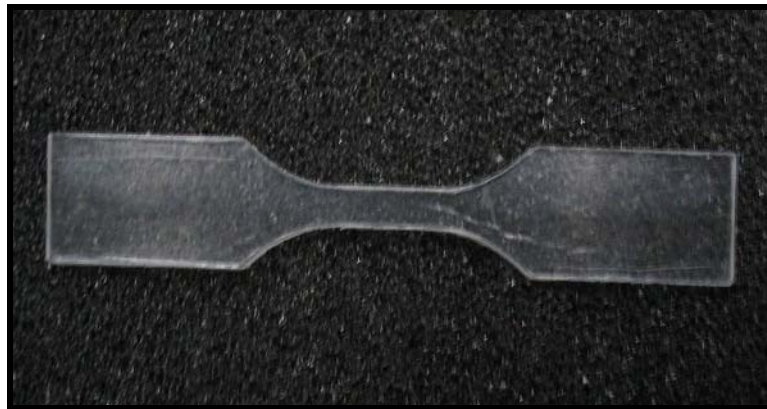
FIG. 4.15 - Aspecto macroscópico do PLDLLA “Como recebido”
