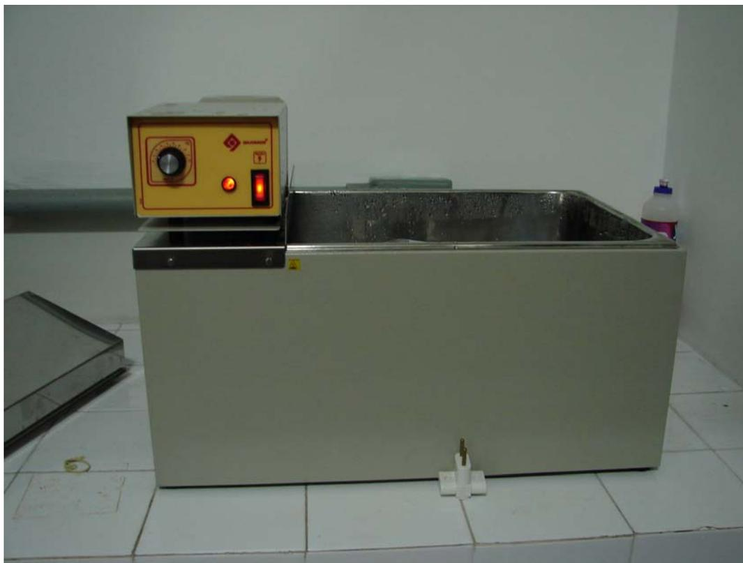
FIG. 3 – Equipamento para realização do “banho maria” do laboratório de Biomateriais do IME usada na degradação das amostras de PTFE.
