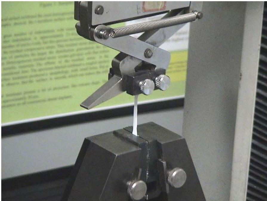
FIG. 5 - Ensaio de tração do PTFE, utilização de uma célula de carga de 20 N.
