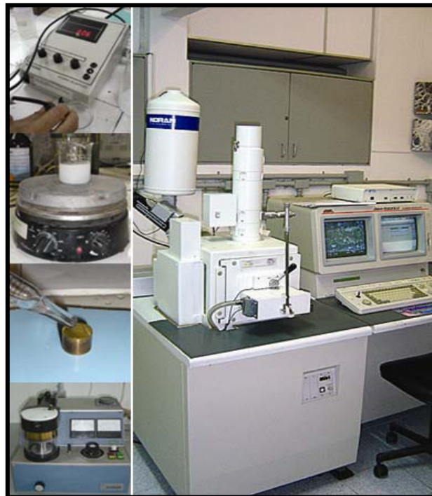
Fig. 3.2: Esquema do processo de preparação das aluminas para análise morfológica em MEV- JEOL- JSM – 5800LV (do laboratório de microscopia do IME)
