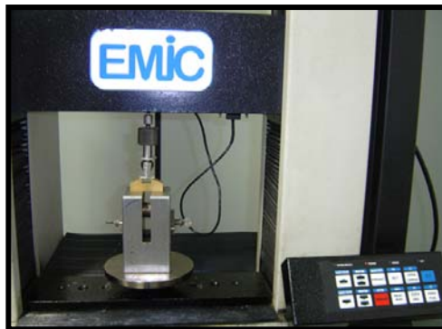
Fig. 3.3: Máquina universal, modelo DL10.000, micro processada, marca EMIC do laboratório de ensaios mecânicos do IME
