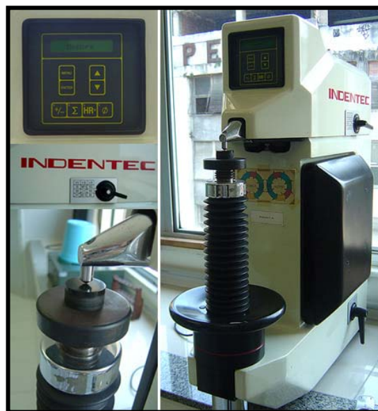
Fig. 3.15: Painel de controle e indentação para análise de dureza Vickers
