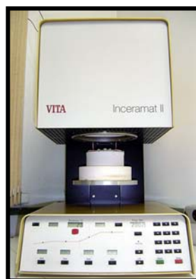
FIG. 2.3: Forno VITA INCERAMAT II específico para sinterização e vitrificação do In-Ceram (foto tirada nas dependências do laboratório credenciado In-Ceram).
