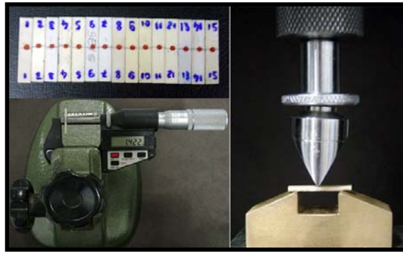
Fig. 3.10: Esquema de corpos de prova, devidamente marcados, suas medidas e ensaio de flexão.
