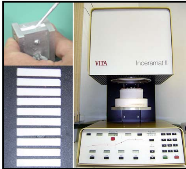
Fig. 3.7: processo de moldagem e sinterização dos corpos de prova
