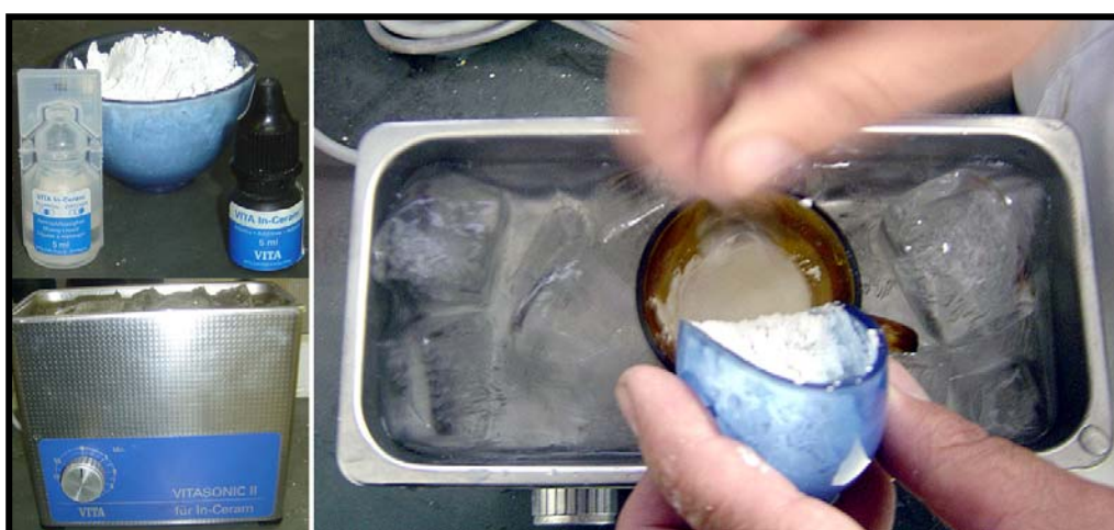
Fig. 3.6: Mistura da barbotina e seus componentes
