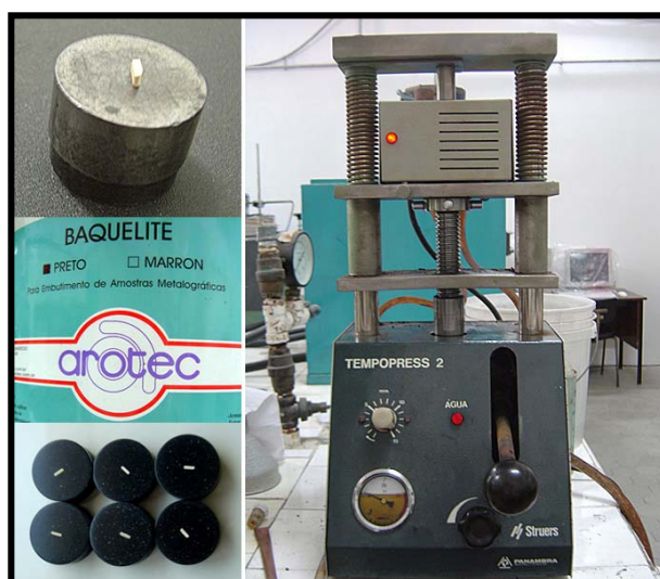
Fig. 3.13: Posicionamento e embutimento dos corpos de prova com baquelite preto
