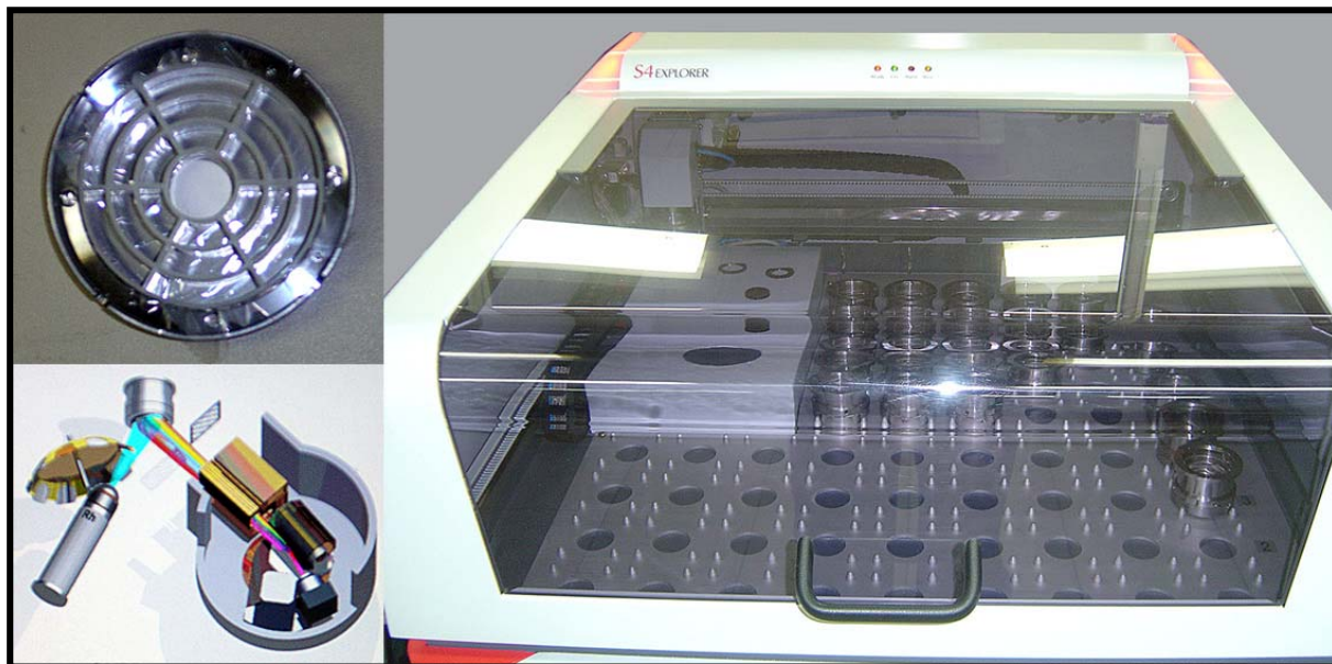
Fig. 3.1: Vista fotográfica da pastilha prensada de alumina In-Ceram, o Tubo de Ródio e o equipamento S4-Explorer (do Centro de Tecnologia Mineral do Ministério da Ciência e Tecnologia - CETEM)
