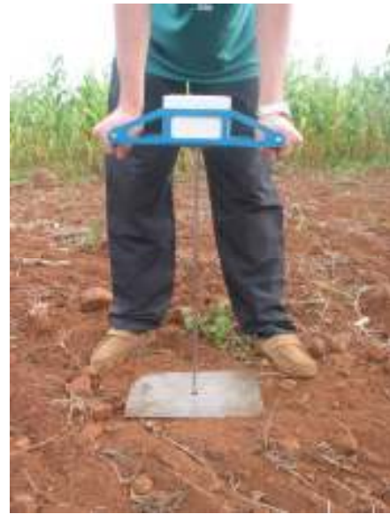
Figura 7 – Obtenção da resistência à penetração do solo com uso de Penetrômetro Digital PNT2000.
