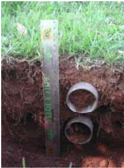
Figura 6 – Coleta das amostras com anel cilíndrico, para determinar a densidade e porosidade do solo.
