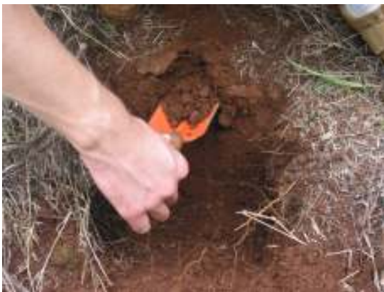
Figura 8 – Coletas de amostras de solo para análise química com uso de espátula.
