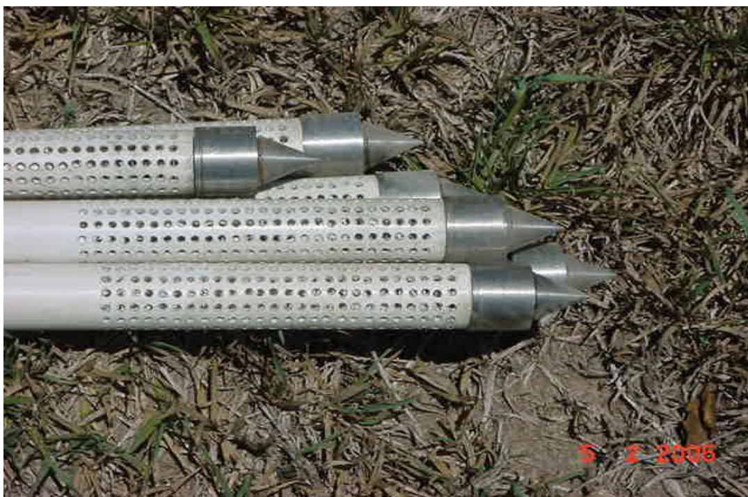
Figura 02 – Piezômetros para testes hidráulicos.
