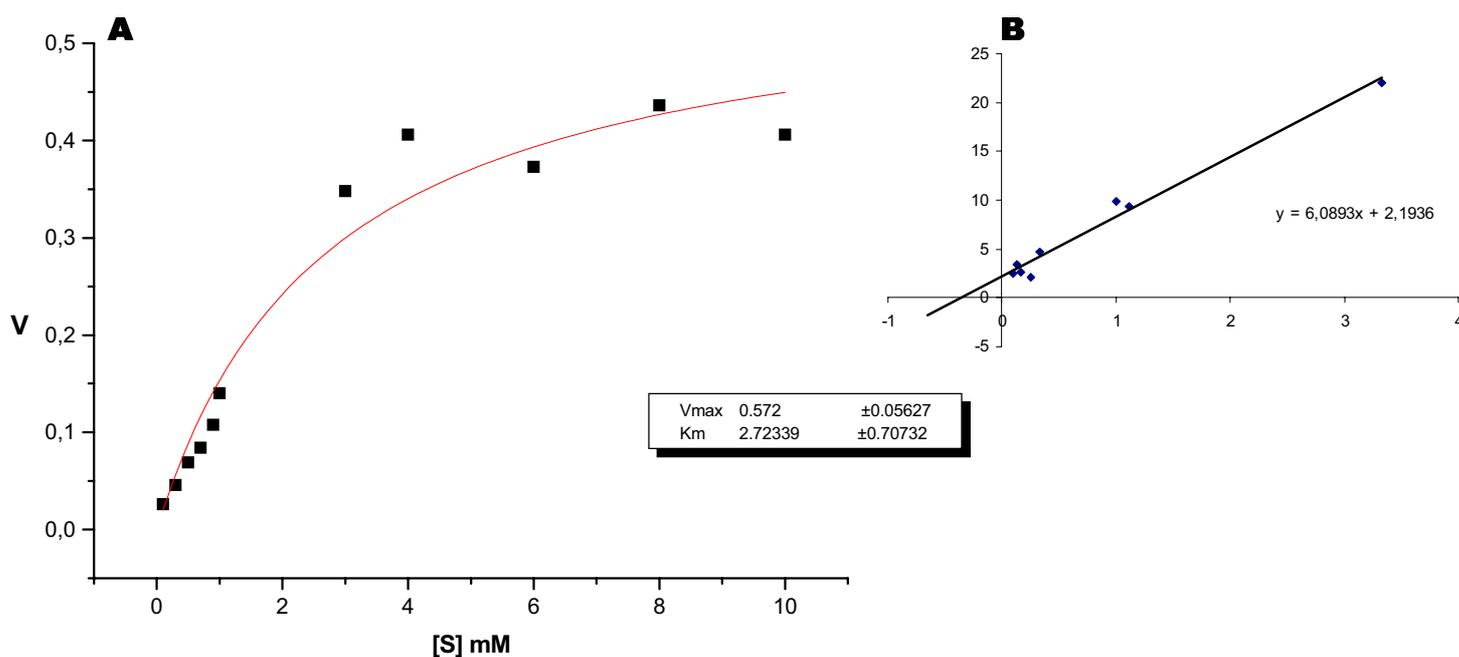
Figura 13: **A.** Determinação do  $K_m$  e da  $V_{m\acute{a}x}$  na hidrólise do p-nitrofenil- $\beta$ -D-glicosaminídeo. **B.** Gráfico do duplo recíproco de Lineweaver-Burk, 1934. A enzima foi incubada com o substrato p-nitrofenil-N-Acetil- $\beta$ -D-glicosaminídeo em diferentes concentrações (0,1 – 10 mM), durante 1 hora a 37°C.
