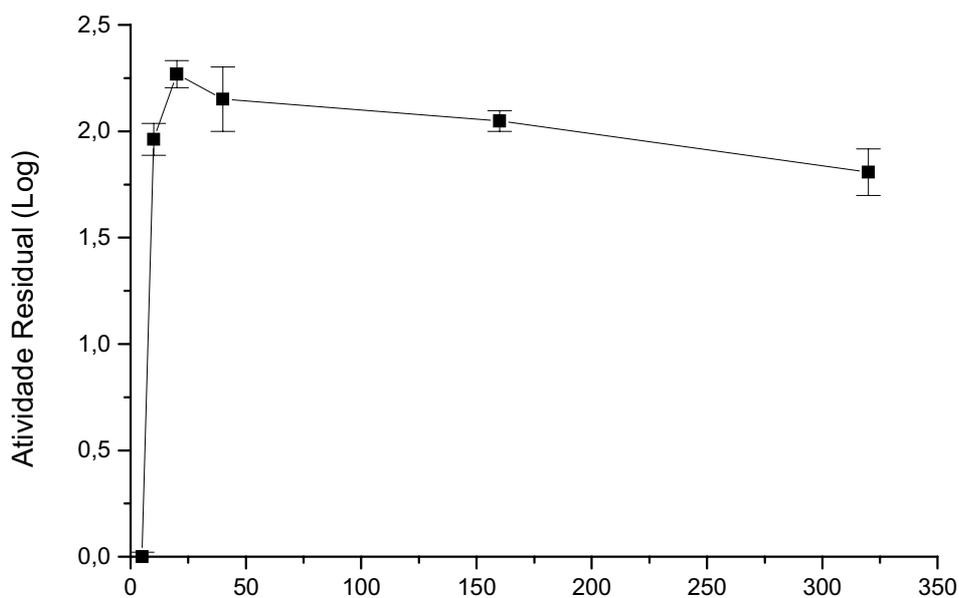
Figura 17: Desnaturação térmica da atividade  $\beta$ -N-Acetilhexosaminidásica. Pré-incubações da enzima a 37°C foram realizadas em diferentes tempos: 5, 10, 20, 40, 160 e 320 minutos. As reações foram interrompidas com hidróxido de sódio 0,25 N e o p-nitrofenol lido a 405 nm em espectrofotômetro, como descrito em materiais e métodos.
