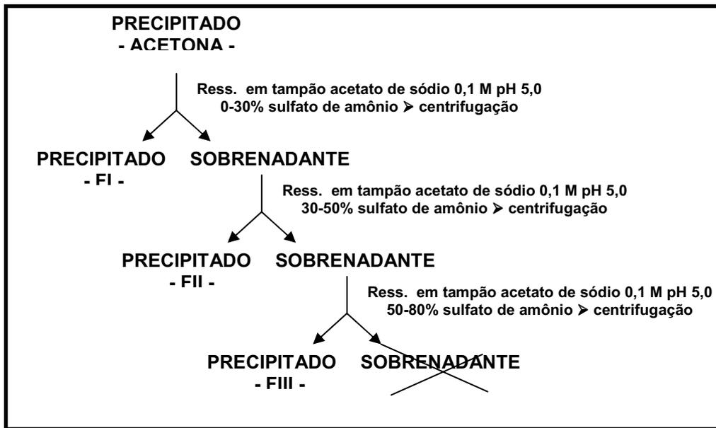
Figura 4: Esquema do fracionamento com sulfato de amônio.
