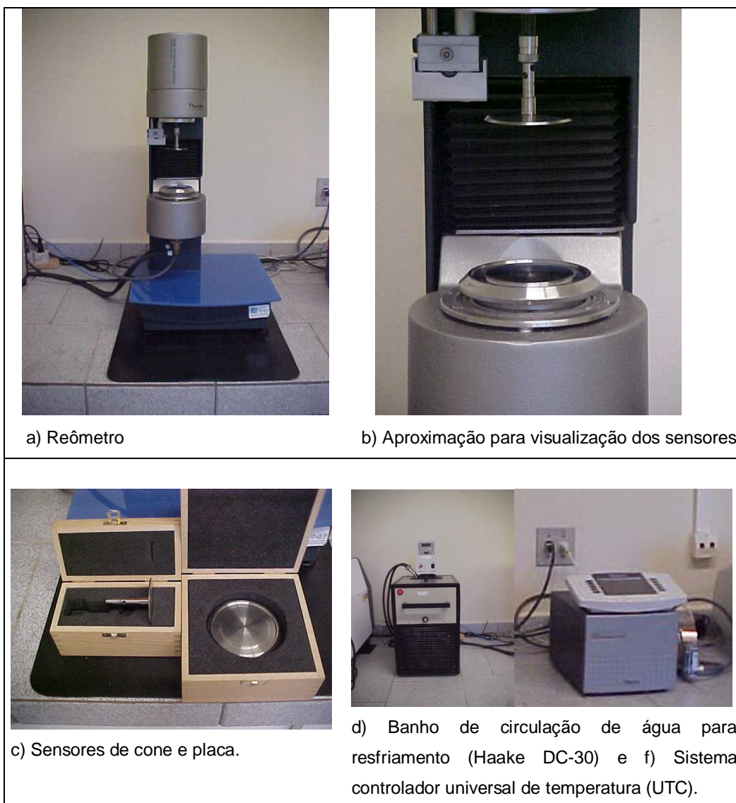
FIGURA 19 – REÔMETRO ROTACIONAL HAAKE RHEOSTRESS 600
