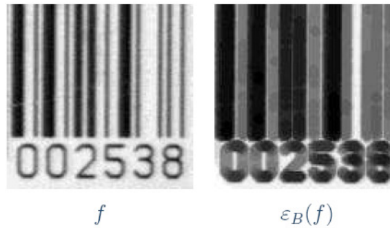
Figura 2.2 : Exemplo de erosão. O elemento estruturante B é um círculo de raio 3 pixels com origem no centro
