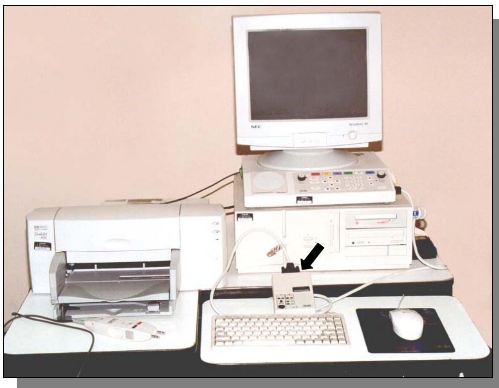
Figura 12. Aparelho Nicolet, modelo Compass Meridien , de 1 canal. No centro, o amplificador (seta)
